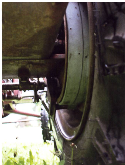
Der «P 55» besitzt ein geschweisstes Chassis und Aussenbandbremsen, das Innenritzel läuft noch nicht im Ölbad.
