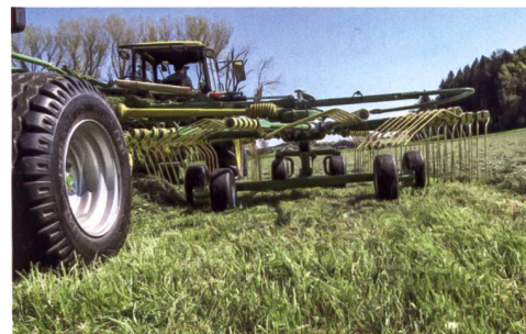
Das Tridem-Fahrwerk war bei der Testmaschine leider nur vorne mit lenkbaren Tasträdern ausgestattet.
