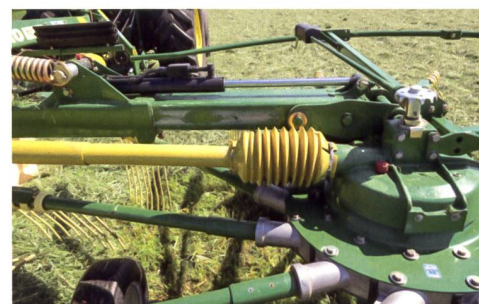
Mit der hydraulischen Breitenverstellung werden die Schwaden 0,8 m bis 1,60 m breit.
