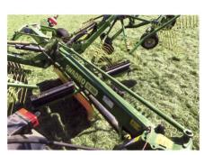
Die Achse verfügt über eine Zwangslenkung, die über eine Stange vom Anbaubock angesteuert wird.
