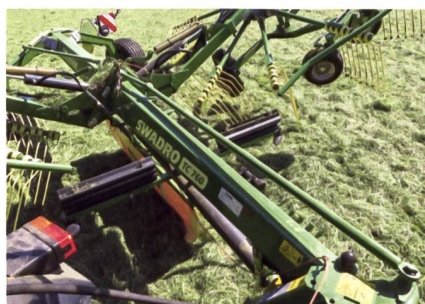
Die Achse verfügt über eine Zwangslenkung, die über eine Stange vom Anbaubock angesteuert wird.
