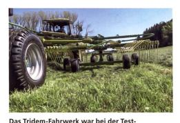
maschine leider nur vorne mit lenkbaren Tasträdern ausgestattet.
