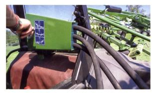
Einfach: die Bedieneinheit für die Einzelkreiselaushebung.
