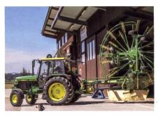
Für kleinere Remisen wird es mit der Höhe von knapp 400cm eng. Klappbare Zinkenarme für 358cm Höhe lohnen sich.
