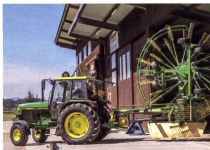
Für kleinere Remisen wird es mit der Höhe von knapp 400 cm eng. Klappbare Zinkenarme für 358 cm Höhe lohnen sich.
