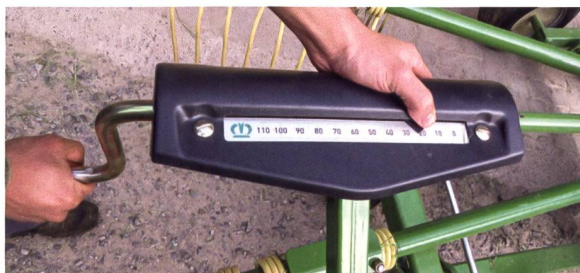
Eine gut ablesbare Anzeige erleichtert die mechanische Höheneinstellung der Kreisel.
