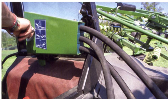
Einfach: die Bedieneinheit für die Einzelkreisel-aushebung.
