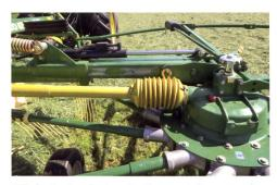
Mit der hydraulischen Breitenverstellung werden die Schwaden 0,8 m bis 1,60 m breit.
