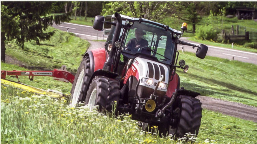
Die neuen «Multi» zeichnen sich durch ein automatisiertes Getriebe, eine Vorderachsfederung und eine Armlehnenbedienung aus.
