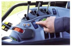
Per Kippschalter kann die «Eco»-Pumpe zugeschaltet werden, sodass die maximale Ölfördermenge bereits bei 1600 U/min erreicht wird.
