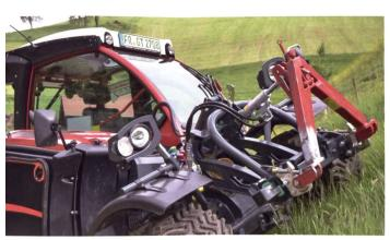
Auffallend ist der grosse Pendelweg der Vorderachse. Selbst an extremen Böschungen sind immer alle vier Räder am Boden.
