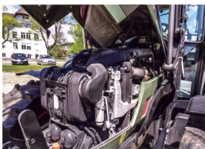
Der elektronisch geregelte Motor erfüllt die Abgasstufe 3b.
