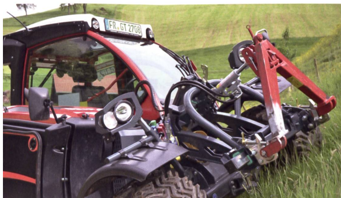
Auffallend ist der grosse Pendelweg der Vorderachse. Selbst an extremen Böschungen sind immer alle vier Räder am Boden.
