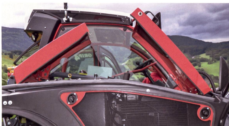
Das Sieb vor den Kühlern wird durch Drehrichtungsumkehr gereinigt. Die Verbrennungsluft für den Motor wird im Kabinendach angesaugt.
