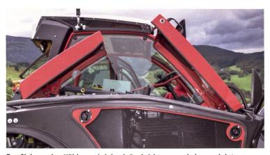
Das Sieb vor den Kühlern wird durch Drehrichtungsumkehr gereinigt. Die Verbrennungsluft für den Motor wird im Kabinendach angesaugt.
