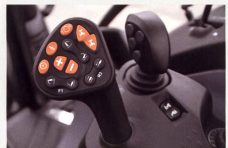
Die neuen «Multi» zeichnen sich durch ein automatisiertes Getriebe, eine Vorderachsfederung und eine Armlehnenbedienung aus.
