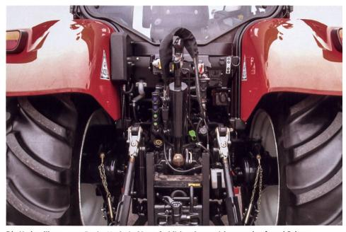
Die Hydrauliksteuergeräte im Heck sind jetzt farblich gekennzeichnet und auf zwei Seiten – links und rechts vom Oberlenker – aufgeteilt.
