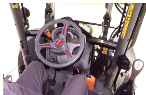
Die 4-Pfosten-Bauweise bietet gute Rundumsicht und einen hellen Arbeitsplatz.
