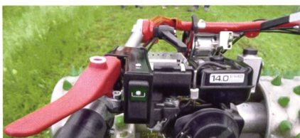
Wird der Totmannschalter losgelassen, stellen Fahrtrieb und Zapfwelle sofort ab. Die Zapfwelle kann während der Fahrt ein- und ausgeschaltet werden.
