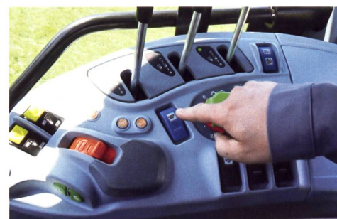
Per Kippschalter kann die «Eco»-Pumpe zugeschaltet werden, sodass die maximale Ölfördermenge bereits bei 1600 U/min erreicht wird.
