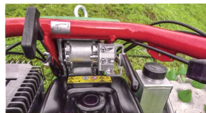
Per Hebel kann man zwischen den Lenkungsarten «Handhebel» und «Holm» umschalten.
