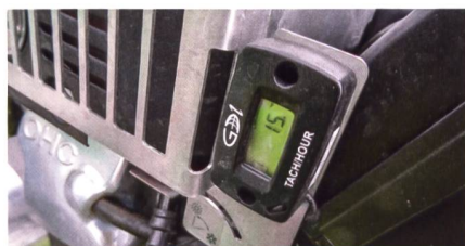
Linksseitig am Motor angebracht, gibt es serienmässig einen Stundenzähler.
