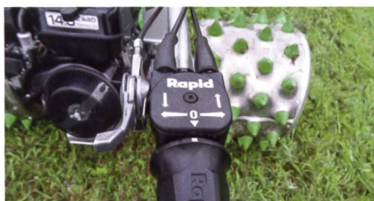
Auch beim «Monta» gibt es den Drehgriff für stufenloses Vor- und Rückwärtsfahren.
