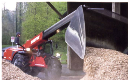
Das Einlagern der Holz schnitzel erleichtert eine Reichweite von 4.45 m
