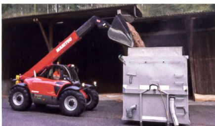
Voluminöse Schaufel, grosse Hubhöhe und viel Hubkraft ergeben eine perfekte Handlingsmaschine für Holz schnitzel
