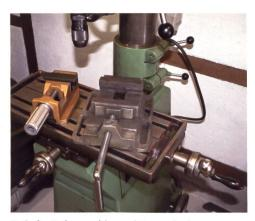
Zu jeder Bohrmaschine gehört auch ein guter Maschinenschraubstock, um Kleinteile sicher zu fixieren.
