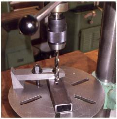
Grössere Werkstücke sind mit Spannpratzen oder zur Not mit Schraubzwingen zu sichern.
