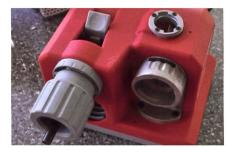
Für Bohrer bis 13 mm gibt es preiswerte Bohrerschleifgeräte. Sie funktionieren recht gut und der Anwender braucht keine Theoriekenntnisse über das Schleifen.
