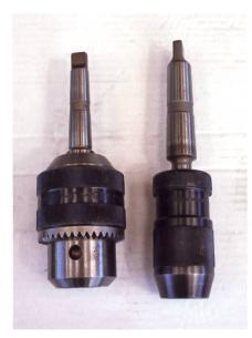
Tischbohrmaschinen für die Betriebswerkstatt sollten mit einer Spindelnase für die Werkzeugaufnahme mit Morsekonus 2 oder 3 ausgerüstet sein. Beim Schnellspannfutter (oben rechts) ist ein Bohrerwechsel werkzeuglos. Beim Zahnkranzbohrfutter muss man den Schlüssel zur Hand haben (zuerst suchen?). Zahnkranzbohrfutter halten jedoch die Bohrer zuverlässiger und kosten weniger.
