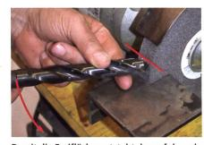
Damit die Freifläche entsteht, kann folgende Methode empfohlen werden: 1. Bohrer so in die Hand nehmen, dass er auf dem aufgelegten Zeigfinger liegt. 2. Schneide parallel zur Schleifscheibenachse ansetzen und leicht gegen die Scheibe drücken. 3. Mit einer Wippbewegung nach unten Schneide und Freifläche nachschleifen.
