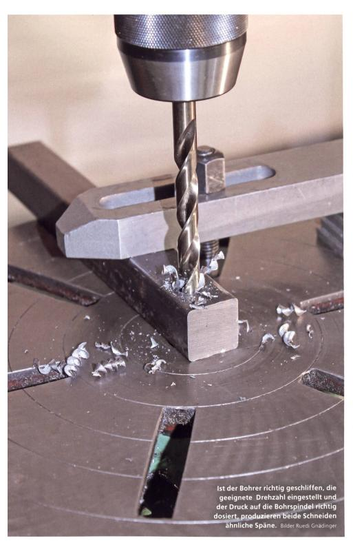
Müssen Löcher mit zu dem zu verschraubenden Gegenstück passen, ist schon eine gewisse Masshaltigkeit gefragt. Die kaum vermeidbare Ungenauigkeit wird in der Regel mit einem Übermass der Löcher gegenüber dem Schraubennenndurchmesser kompensiert. Das empfohlene Übermass beträgt bei Schrauben M4 bis M8 ca. 0,5 mm und ab M10 ca. 1 bis 2 mm. Um aber die verlangte Genauigkeit zu erreichen, ist genaues Anreissen und Körnern gefragt.
