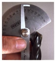
Immer wieder den Schleifvorgang unterbrechen, den Bohrer kühlen und anschliessend Spitzenwinkel und die Schneidenlänge auf Gleichmässigkeit prüfen.
