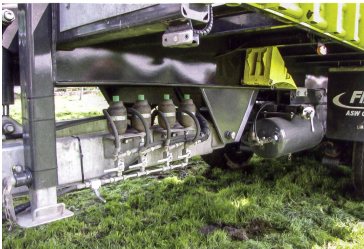
Blick unters Chassis mit der hydraulischen Zanglenkung.
