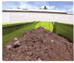
Zur Gewichtsoptimierung tragen Alu-Mulde und Rahmenkonstruktion aus Feinkornstahl bei.
