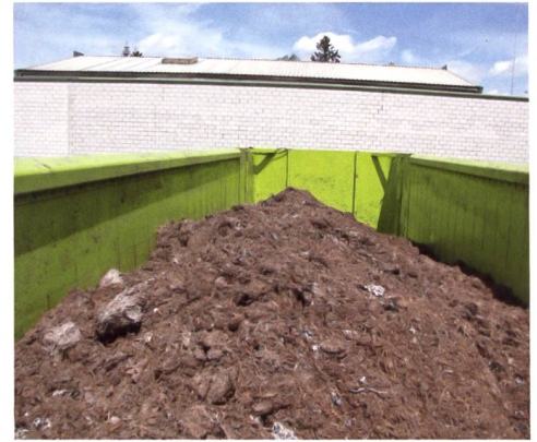
Zur Gewichtsoptimierung tragen Alu-Mulde und Rahmenkonstruktion aus Feinkornstahl bei.
