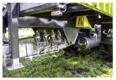
Blick unters Chassis mit der hydraulischen Zangslenkung.
