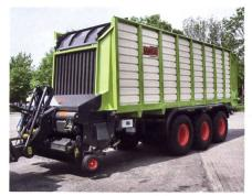
Der klassische Kombiwagen eignet sich sowohl als Kurzschnitt-Silierwagen, als auch als Häckseltransportwagen. Im Bild ein Thorium 55 von Kaweco. Bild: Kaweco
