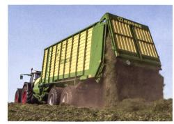
Zur Beschleunigung des Entladevorganges bei Krone-Kombiwagen tragen der doppelseitiger Kratzbodenantrieb und die konische Ausformung des Laderaumes bei. Bild: Krone
