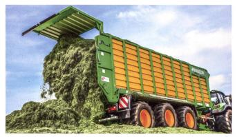
Fast alle Fabrikate haben mittlerweile eine hydraulische oder hydropneumatische Fahrgestellfederung, die das Gewicht auf alle sechs Räder verteilt. Bild: Joskin
