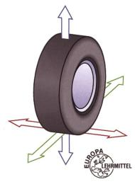
■ Vertikalkräfte (Dämpfung und Komfort) ■ Seiten-/Lateralkräfte (Lenkkontrolle/Seitenführung)
