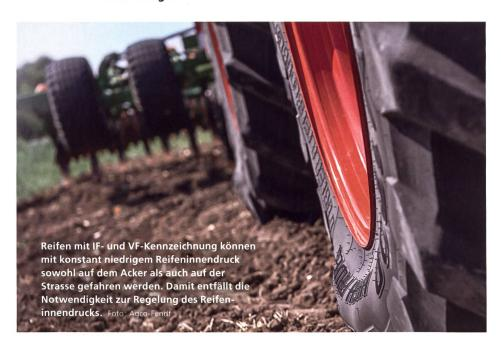
Geschwindigkeit mit geringerem Reifeninnendruck gefahren werden, die Notwendigkeit zur Druckanpassung entfällt somit. Diese Reifen werden mit dauernd tiefem Reifeninnendruck sowohl auf dem Acker als auch auf der Strasse gefahren.
