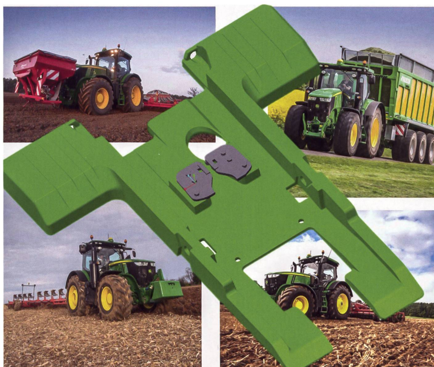
Beim EZ-Ballast-System von John Deere wird das Gewicht unterhalb des Traktors aufgenommen und getragen. Durch diese Tragart wird eine ausgeglichene Achsverteilung erzielt.
