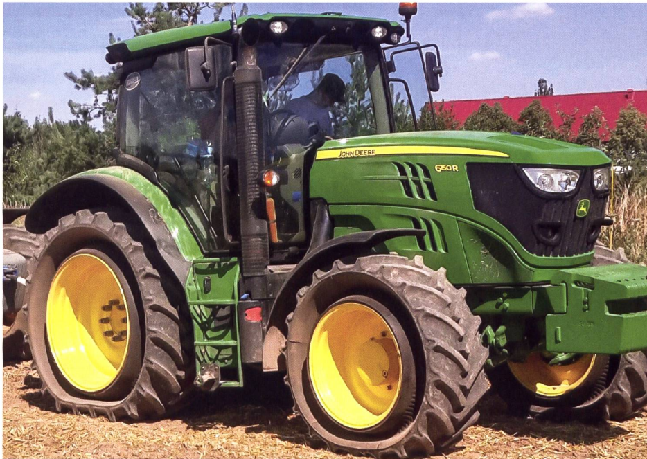
Die gemeinschaftliche Entwicklung von Mitas und Galileo Wheel geht ganz neue Wege. Der «PneuTrac» hat eine wesentlich grössere Aufstandsfläche. Die Markteinführung ist auf Ende des kommenden Jahres vorgesehen.
