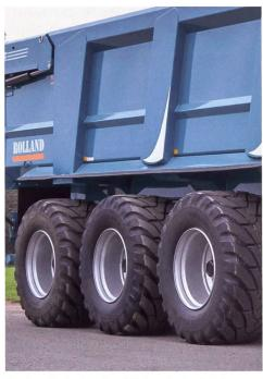
Dank optimiertem Laufflächendesign ist die Bodenaufstandsfläche trotz grossen Profilzwischenräumen bei Flotationsreifen grösser als bei herkömmlichen Reifen.
