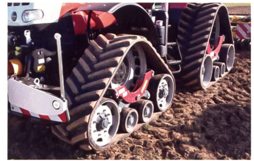
Weil breite Reifen zunehmend die gesetzlichen Rahmenbedingungen sprengen, gibt es bei Traktoren, Erntemaschinen und Transporttechnik einen Trend zum Raupenlaufwerk.
