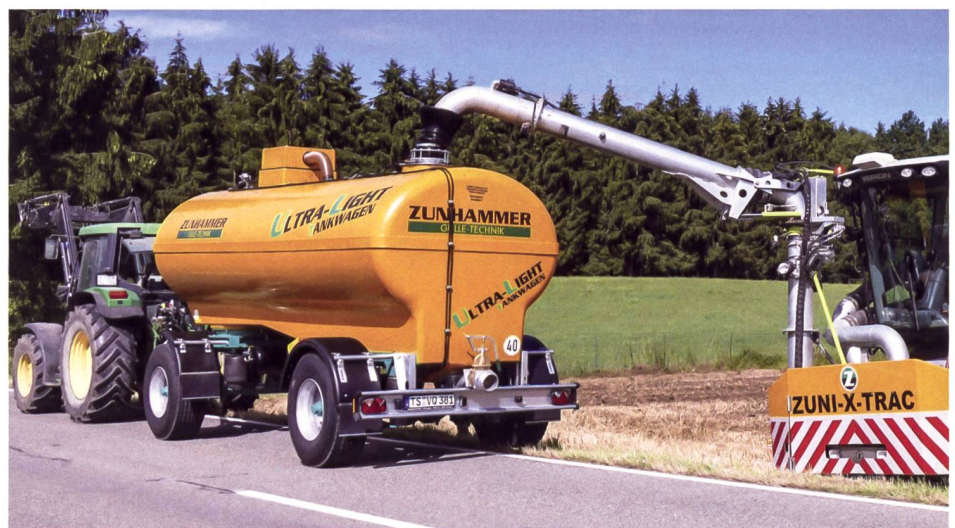
Selbsttragende GFK-Konstruktionen ohne Tragrahmen reduzieren das Leergewicht, stellen aber hohe Anforderungen an die Stabilität. Unter dem Strich erhöht sich die Transportmenge um das eingesparte Gewicht (ca. 1000 kg/lt). Bild: Zunhammer
