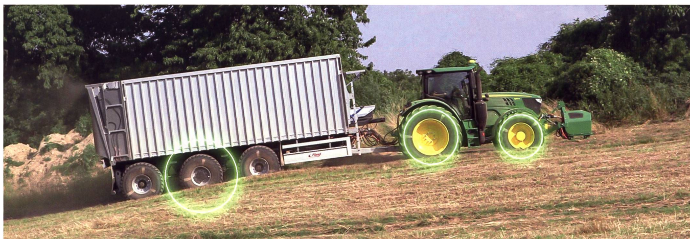
Die Gemeinschaftsentwicklung «sDrive» von John Deere / Fliegl beinhaltet eine elektrisch angetriebene Anhängerachse, deren Antriebsleistung der Traktor je nach dem Ladezustand steuert. Als Stromquelle dient ein Frontzapfwellengenerator. Bild: John Deere
