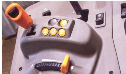
Neue Getriebevariante: Das «CommandQuad Plus» bietet einen vollautomatischen Betrieb.
