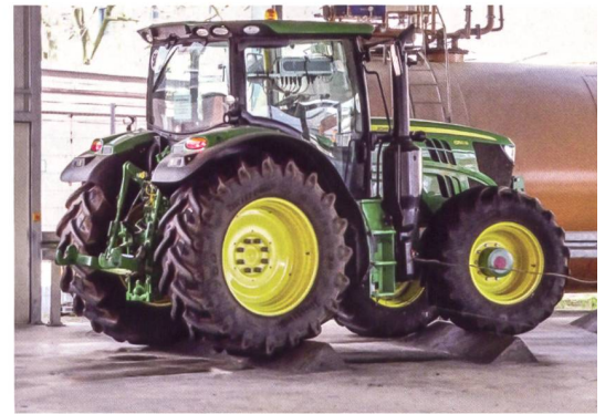
Fokus auf Produktqualität: 10 000 Stunden auf der Rüttelpiste sind eine echte Tortur für einen Traktor.
