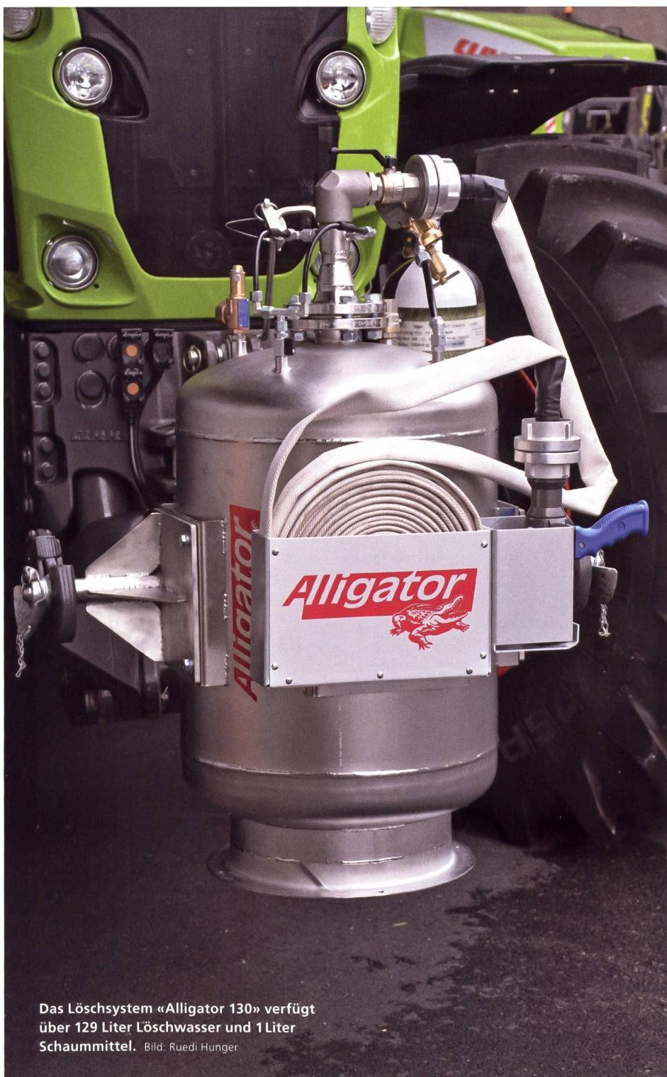
Das Löschanalyse «Alligator 130» verfügt über 129 Liter Löschwasser und 1 Liter Schaummittel. Bild: Ruedi Hunger
