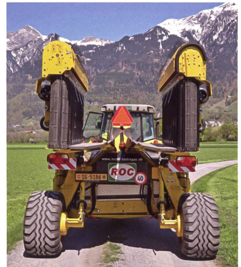
Kompakt gebaut und 4,5 t schwer. Dieser Bandschwader ist mit Druckluftbremsen ausgerüstet und bietet daher auch auf der Strasse ein hohes Mass an Sicherheit.
