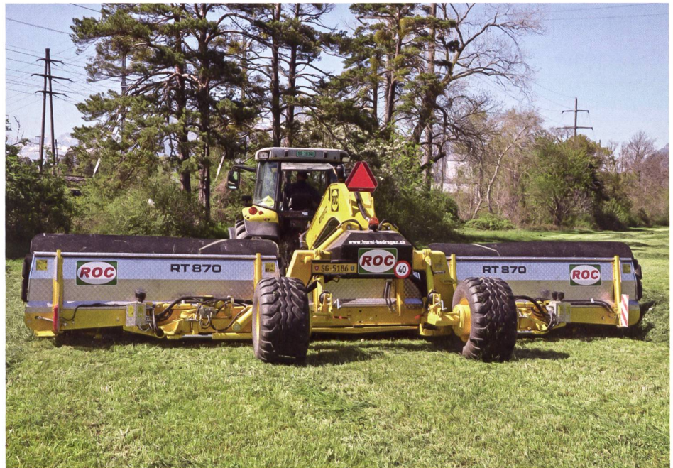
Dieser Bandschwader verfügt über drei Einzelsegmente, die sich trotz neun Metern Arbeitsbreite (mit Schwad) gut dem Boden anpassen können.
