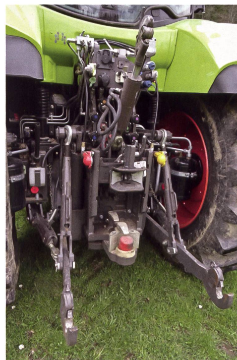
Die Hydraulikausstattung ist gut und bietet einen Load-Sensing-Kreislauf mit Axialkolbenpumpe und bis zu 110 l/min Förderleistung.
