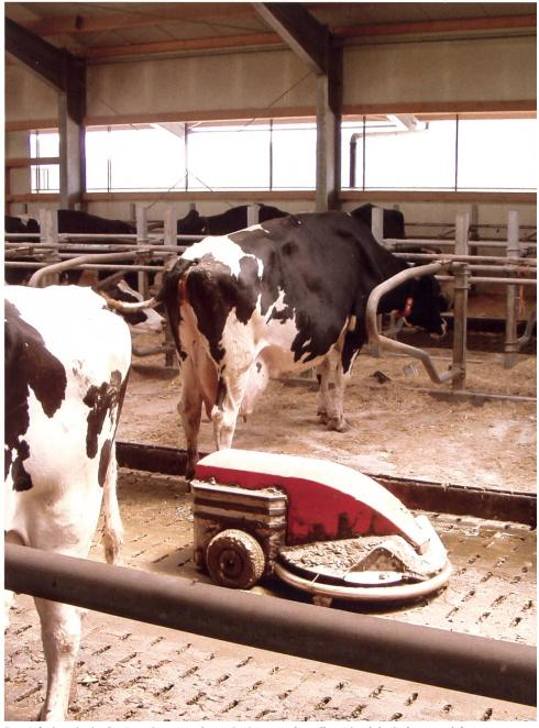
Das Arbeitsprinzip der Entmistungsroboter ist in etwa dasselbe: Die elektrisch angetriebenen Roboter sind programmierbar, freibeweglich und reinigen die Spalten mittels Gummilippe. Nach einer bestimmten «Arbeitszeit» suchen sie selbstständig die Ladestation auf.
