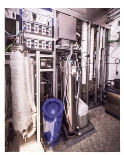
Reaktor: In zwei isolierten Reaktoren wird aus Wasserstoff und Kohlendioxid Methan.
