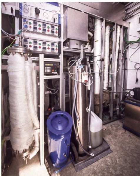
Reaktor: In zwei isolierten Reaktoren wird aus Wasserstoff und Kohlendioxid Methan.
