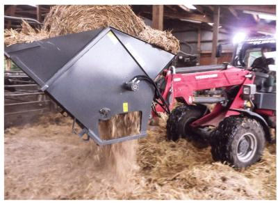
Ein unten offenes Gerät ohne seitliches Austragband überdeckt die Liegefläche streifenweise mit frischer Einstreu. Bild: Mehrtens
