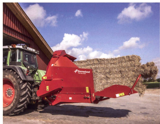
Angebaute Auflöse- und Verteilgeräte bewältigen auch Quaderballen. Entsprechend schwer muss aber der Traktor sein. Bild: Kverneland
