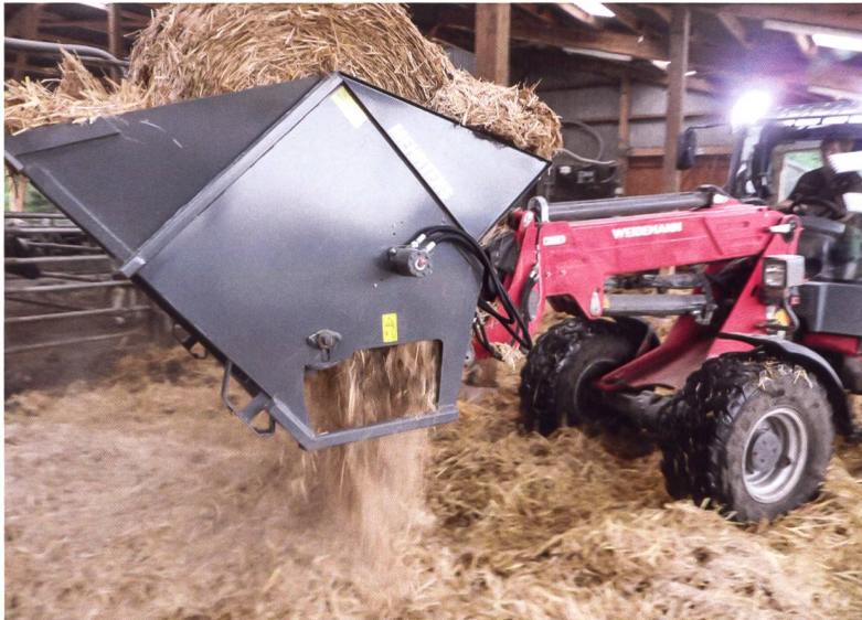
Ein unten offenes Gerät ohne seitliches Austragband überdeckt die Liegefläche streifenweise mit frischer Einstreu. Bild: Mehrtens
