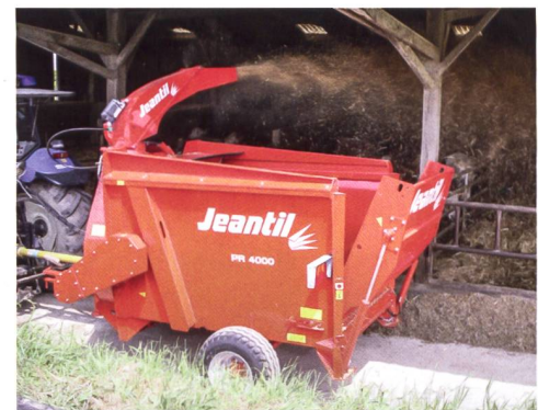
Da für den Traktor keine Hubkräfte entstehen, können gezogene Auflöse- und Verteilgeräte auch mit kleineren Traktoren betrieben werden. Bild: Jeantil
