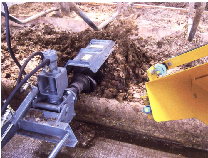
Boxenplaner sind hydraulisch angetriebene Geräte. Sie dienen zum Auflockern und Planieren der Liegeboxen-Einstreu.
