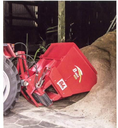
Das Befüllen erfolgt rasch und übersichtlich in Rückwärtsfahrt. Bild: BVL
