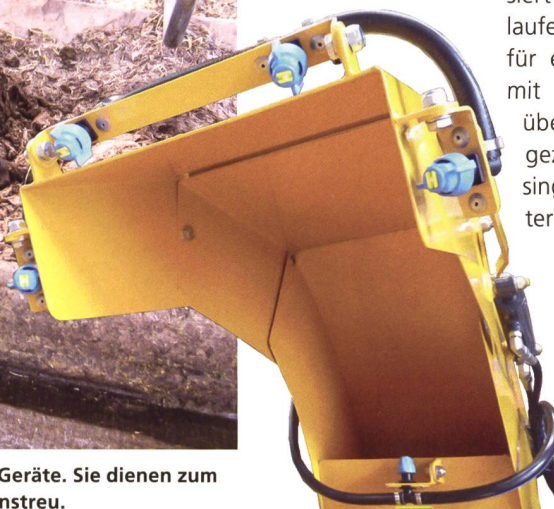
Das Auflösen und Einblasen von Stroh kann zu erheblicher Staubbelastung führen. Mittels eines Düsenkranzes wird Wasser direkt ins Stroh eingespritzt und damit der Staub zum Teil gebunden.
