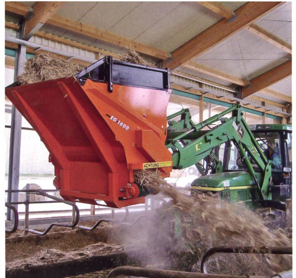
Angebaut am Frontlader hat der Fahrer zum Befüllen und Austragen gute Übersicht. Bild: Sauerburger
