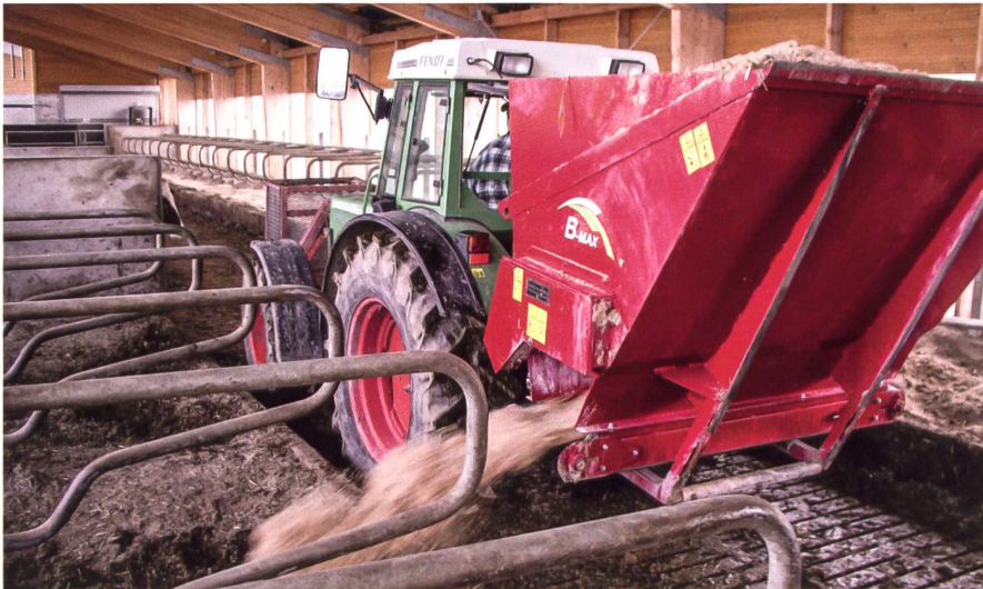
Angebaut an der Heckhydraulik, ist die Austragshöhe beschränkt, reicht aber für den «Normalfall» aus. Bild: BVL
