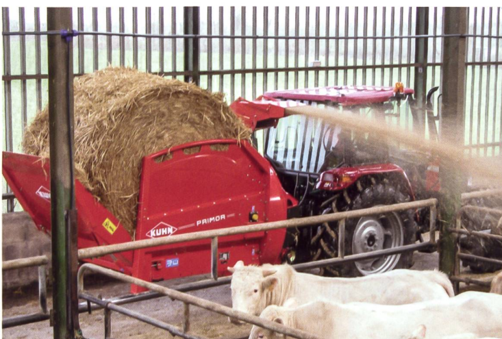
Das Auflösen und Einblasen mittels getragenen Auflöse- und Verteilgeräten erfolgt vielfach vom Futtertisch aus. Dabei kann nicht verhindert werden, dass sich Staub- und Einstreupartikel im Fell der Tiere festsetzen. Bild: Kuhn
