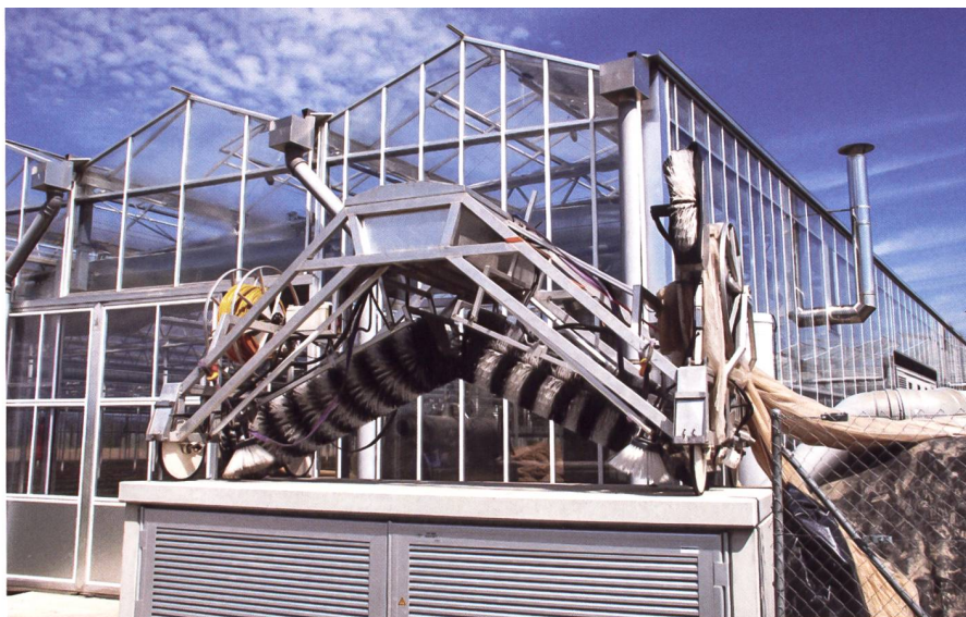
Dank dieser Eigenbau-Dachwaschmaschine wird die Sonnenstromproduktion optimiert.
