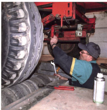
Häufig war der Bremszylinder am Anschlag, was mit wenigen Handgriffen vor Ort behoben werden konnte.
