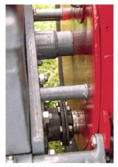
Die Ritzelachse (Innenritzel) unten, rechts angeschnitten das rote Bremsband der Fussbremse.
