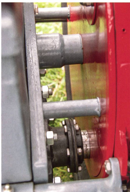
Die Ritzelachse (Innenritzel) unten, rechts angeschnitten das rote Bremsband der Fussbremse.
