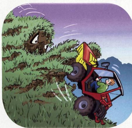
Einsatzgrenzen sind abhängig von der Geländestruktur, von Boden- und Sichtverhältnissen und von der Ausrüstung.
