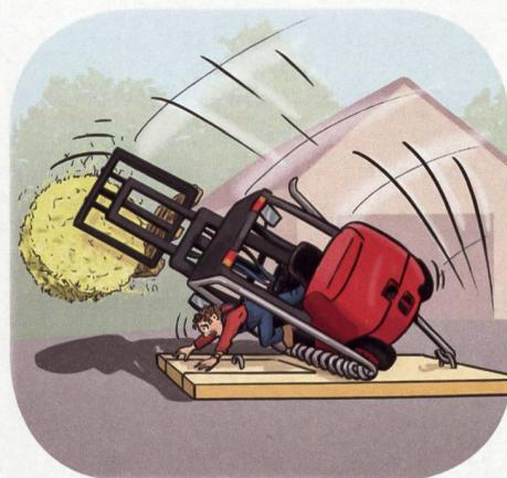
Stapler und Hoflader müssen mit Kabine und einem wirksamen Rückhaltesystem ausgerüstet sein.
