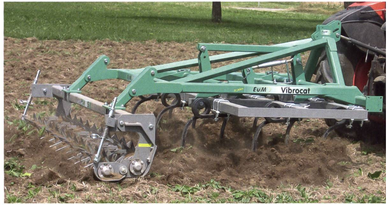
Sterncrackerwalze an einem Grubber «Vibrocot» von EuM: Unkräuter, hier Ampfer, werden an die Bodenoberfläche gebracht, wo sie sicher abtrocknen.
