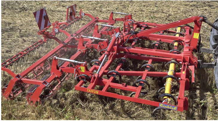
Mehrbalkige Federzinkengrubber wie dieser Einböck «Taifun» eignen sich gut für die mechanische Unkrautbekämpfung. Winkelstabwalzen und Striegel enterden die abgeschnittenen Unkräuter.
