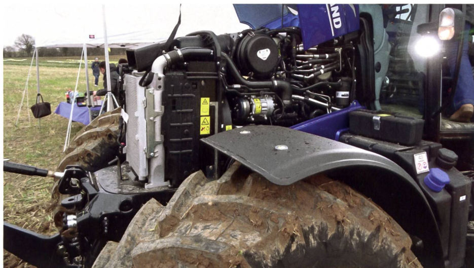
Die Motoren erfüllen die Abgasstufe 4 mit SCR-Nachbehandlung, brauchen aber keinen Dieselpartikelfilter und auch keinen Dieseloxydationskatalysator.
