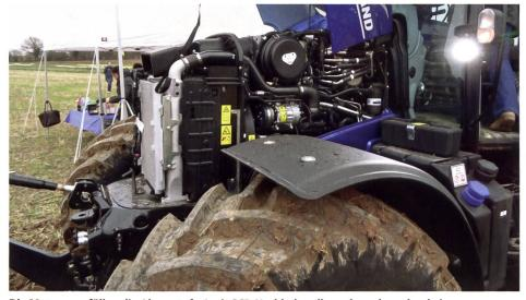
Die Motoren erfüllen die Abgasstufe 4 mit SCR-Nachbehandlung, brauchen aber keinen Dieselpartikelfilter und auch keinen Dieseloxidationskatalysator.
