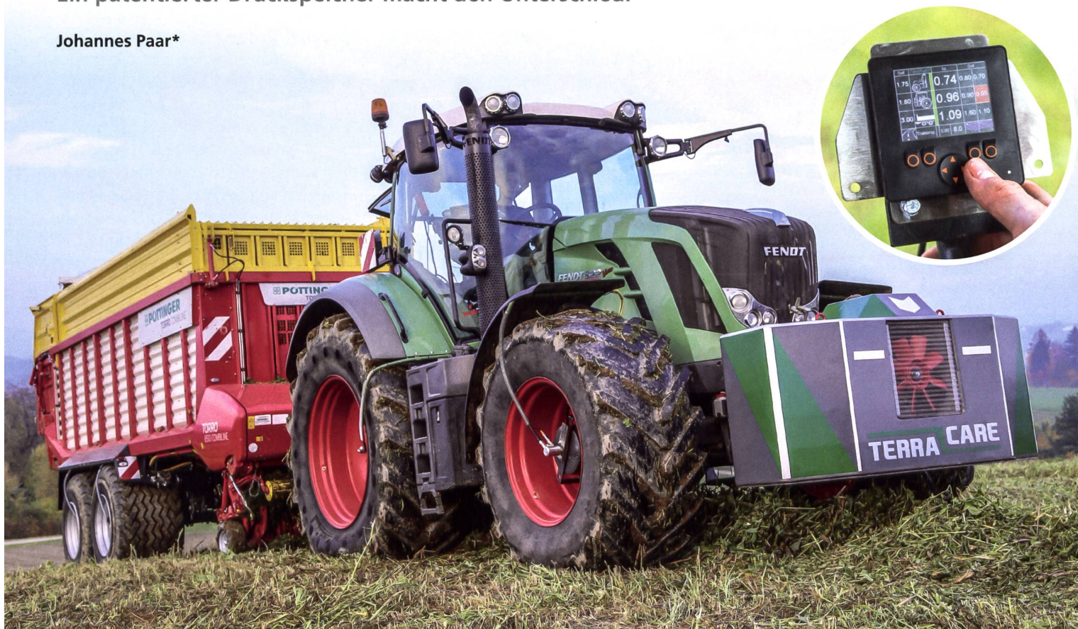
Das «TerraCare»-System in Verbindung mit einem Ladewagen. Über das Terminal kann bei den einzelnen Rädern zwischen den Einstellungen «Strasse», «Feld flach» und «Feld steil» gewählt werden. Bilder: Christian Leitner
