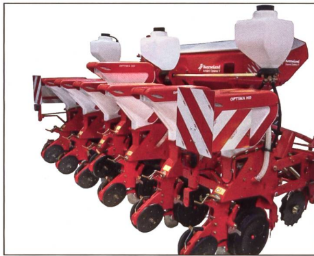
Für die Saison 2016 gibt es zur «Optima» ein «SpeedKit» in beschränkter Anzahl. Diese Aufrüstung erlaubt höhere Sägeschwindigkeiten bei gleichbleibender Genauigkeit.
