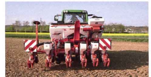
Teleskoprahmen und nach vorne versetzte Räder bringen ein hohes Mass an Flexibilität, sowohl für den Strassentransport als auch für die Wahl des optimalen Reihenabstandes. Bild: Kuhn
