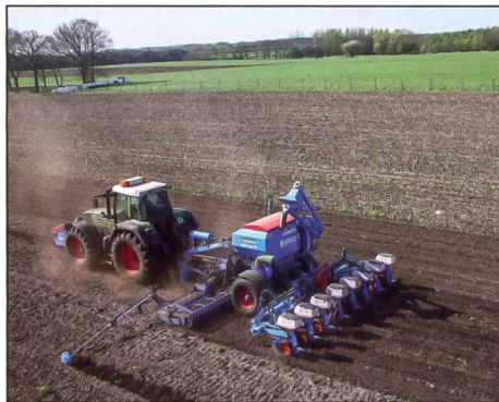
Ein Trend bei Grossflächentechnik: Fahrwerk mit Bodenbearbeitungsgerät wird zum «Trägefahrfahrzeug» für Einzelkornsätechnik (Bild) oder herkömmlicher Getreidesätechnik. Bild: Lemken
