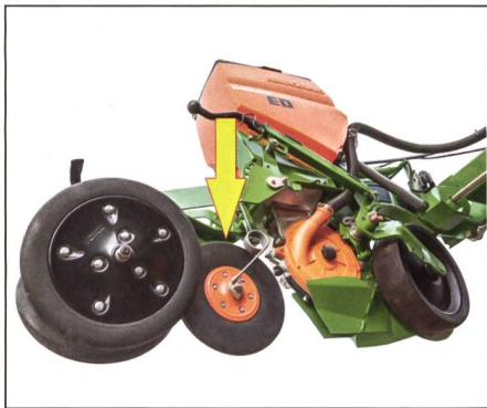
Mehr Laufruhe dank zusätzlicher Saandruckrolle verspricht Amazone beim Säaggregat «ED-Contour». Bild: Amazone
