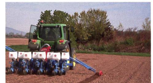
«TwinRow» ist ein Ablageverfahren mit zwei naheliegenden Einzelreihen, die parallel nebeneinander verlaufen. Dadurch wird im Vergleich zu einer Einzelreihe der Standraum je Pflanze deutlich vergrössert.
