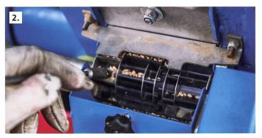
rädern. Je nach Saatgut und Aussaatmenge (1,5 bis 500 kg) können die einzelnen Teile zu- oder abgeschaltet werden. Dazu gibt es Hinweise in der Sätabelle und ein mitgeliefertes Werkzeug. Die Bodenklappen lassen sich mit einem Hebel am rechten Dosierer gemeinsam einstellen.
