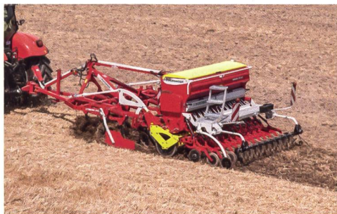
Gezogene Baukonzepte – hier auf der Basis eines Grubbers – ermöglichen mehr Distanz zwischen den einzelnen Bearbeitungselementen.
