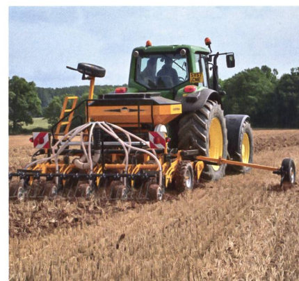
Die partielle Bodenbearbeitung kann getrennt von der Saat durchgeführt werden oder (wie im Bild) in einem kombinierten Durchgang (1- oder 2-phasig).
