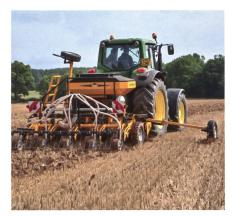
Die partielle Bodenbearbeitung kann getrennt von der Saat durchgeführt werden oder (wie im Bild) in einem kombinierten Durchgang (1- oder 2-phasig).
