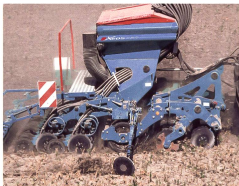
Die Mulchsaat in Verbindung mit einer Kurzscheibenegge kann auch im 3-Punkt-Anbau erfolgen. Gezogene Maschinenkonzepte sind nicht zwingend.
