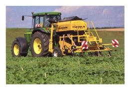
Wenn die Saatgutablage in Reihen oder Bändern ohne vorherige Bodenbearbeitung erfolgt, ist der Bodeneingriff nur so gross, wie dies für die Saatgutablage nötig ist.
