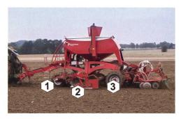
In einem ersten Schritt wird der Boden eingeebnet (1), anschliessend das Saatbett bereitet (2) und schliesslich wird vor dem Säen rückverdichtet (3).
