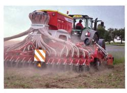
Kurzscheibeneggen-Saat: Die mischende, nicht wendende Bodenbearbeitung reduziert die Bedeckung der Oberfläche mit organischen Reststoffen um 45–65%.
