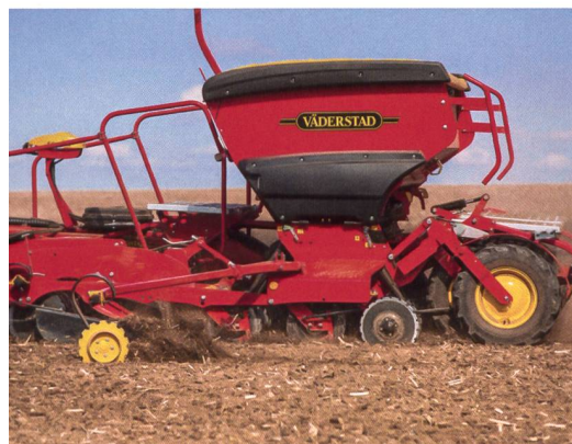
Für lockere Böden bewährt sich eine Rückverfestigung vor der Saatgutablage. In Böden, wo sich die Saattrille nicht leicht schliesst, erfolgt die Rückverfestigung nach der Säschar (wie im Bild).
