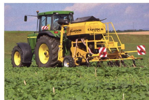
Wenn die Saatgutablage in Reihen oder Bändern ohne vorherige Bodenbearbeitung erfolgt, ist der Bodeneingriff nur so gross, wie dies für die Saatgutablage nötig ist.
