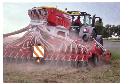
Kurzscheibeneggen-Saat: Die mischende, nicht wendende Bodenbearbeitung reduziert die Bedeckung der Oberfläche mit organischen Reststoffen um 45–65 %.
