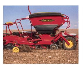
Für lockere Böden bewährt sich eine Rückverfestigung vor der Saatgutablage. In Böden, wo sich die Saatrille nicht leicht schliesst, erfolgt die Rückverfestigung nach der Säschar (wie im Bild).
