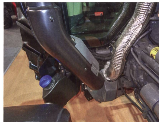
Die Motoren erfüllen die Abgasnorm der Stufe 4 mit SCR und DOC. Interessant ist die «all-in-one»-Abgasreinigungsanlage, die vorne rechts, unter der Kabine, platziert ist.
