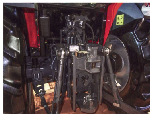
Serienmässig gibt es für die Steuerventile und das Heckhubwerk ein Open-Centre-Hydrauliksystem mit einer Zahnradpumpe (58l/min), optional eine Tandempumpe mit 100l/min (58 und 42l/min).
