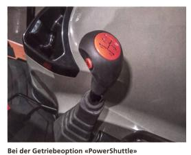
gibt es am Schalthebel einen Kupplungsknopf, sodass eine Ganggruppe ohne Kupplungspedal durchgeschaltet werden kann.
