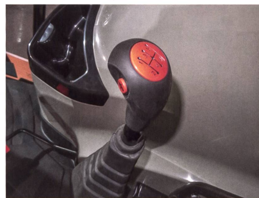
Bei der Getriebeoption «PowerShuttle» gibt es am Schalthebel einen Kupplungsknopf, sodass eine Ganggruppe ohne Kupplungspedal durchgeschaltet werden kann.
