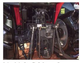
Serienmässig gibt es für die Steuerventile und das Heckhubwerk ein Open-Centre-Hydrauliksystem mit einer Zahnradpumpe (581/min), optional eine Tandempumpe mit 1001/min (58 und 421/min).
