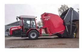
tor. Der Fahrantrieb ist mechanisch mit Lastschaltung und einer elektrohydraulischen Wendeschaltung. Die Ausdosierung erfolgt links und rechts über ein Querförderband.
