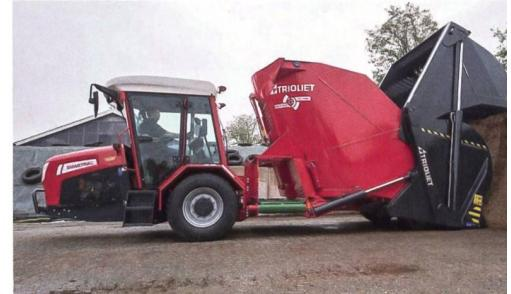
tor. Der Fahrantrieb ist mechanisch mit Lastschaltung und einer elektrohydraulischen Wendeschaltung. Die Ausdosierung erfolgt links und rechts über ein Querförderband.
