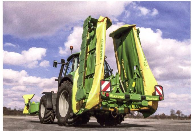
Front-Heck-Mähwerkombinationen, die horizontal transportiert werden, verdecken immer die Rücklichter des Traktors. Es ist deshalb wichtig, dass sie in Fahrtrichtung hinten ausreichend signalisiert sind und über eine Blink-Lichtanlage verfügen. Bild: zvg
