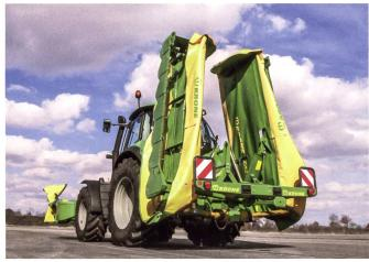
Front-Heck-Mähwerkkombinationen, die horizontal transportiert werden, verdecken immer die Rücklichter des Traktors. Es ist deshalb wichtig, dass sie in Fahrtrichtung hinten ausreichend signalisiert sind und über eine Blink-Lichtanlage verfügen. Bild: zvg
