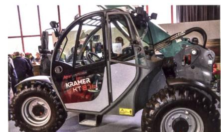
verfügen über Allradlenkung und gutes Stehvermögen. Während der neue Teleskoplader mit einem 55-kW-Motor ausgerüstet ist, leistet der Motor im «KL 25.5T» rund 35 kW. Kramer-Allrad-Produkte aus dem Werk in Pfullendorf (D) werden durch Agrar Landtechnik AG in Balterswil vertrieben.
