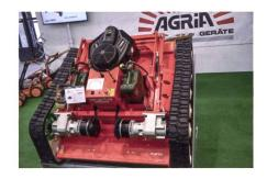
tes Steuern der Maschine. Als Antriebsquelle für das innovative Hybrid-Antriebskonzept dient ein knapp 20 kW starker Verbrennungsmotor. Der als Sichelmulcher konzipierte Mäher arbeitet 1,12 m breit und kann identisch für die Vorwärts- und die Rückwärtsfahrt eingesetzt werden.
