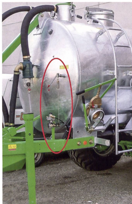
Automatisch lastabhängige Bremskraftregler (ALB) sorgen für dosiertes Bremsen bei unterschiedlichen Beladungszuständen. Hier wird mittels Füllstandsanzeige und Drahtseil die Bremskraft am Regler eingestellt. Bild: Hunger
