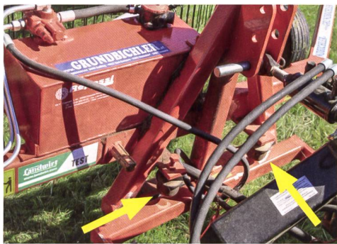
Pendel-Dreipunktbock mit einstellbaren Gummianschlägen (Pfeile).
