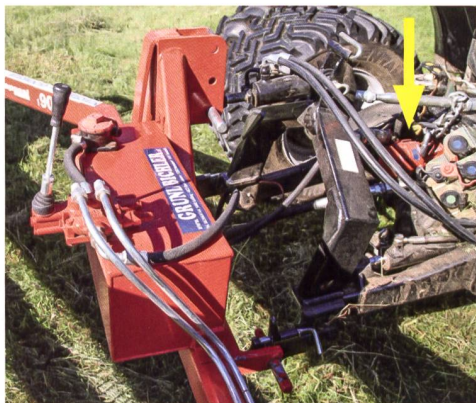
Eigene Ölversorgung mit aufsteckbarer Zapfwellenpumpe (Pfeil).
