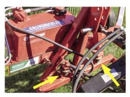
Pendel-Dreipunktbock mit einstellbaren Gummianschlägen (Pfeile).
