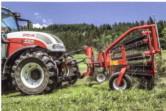
Der Schwader wird über zwei Tasträder geführt ...
