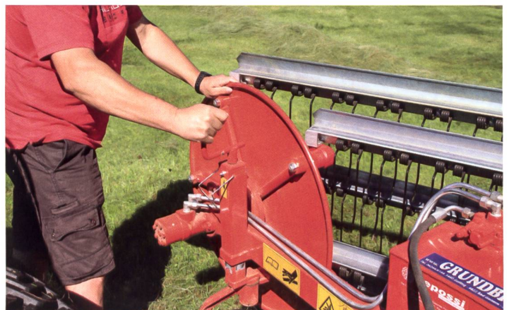
... die sich mit Handkurbeln stufenlos in der Höhe verstellen lassen.
