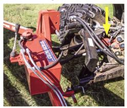
Eigene Ölversorgung mit aufsteckbarer Zapfwellenpumpe (Pfeil).
