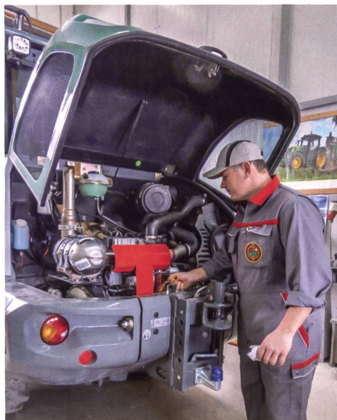
Die einteilige und weit öffnende Motorhaube erlaubt einen hervorragenden Zugang zu den Wartungspunkten und Servicestellen.
