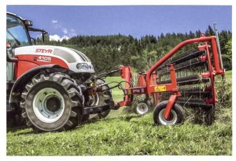
Der Schwader wird über zwei Tasträder geführt ...
