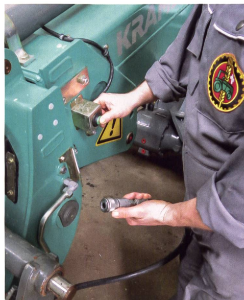
Eine Taste für die Druckentlastung erleichtert das Umstecken der Schläuche vom Wechselrahmen auf das Anbaugerät.
