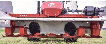
Mithilfe von Schwadtrommeln oder Schwadscheiben wird eine kompakte Schwad gebildet, die der nachfolgende Ladewagen sauber aufnehmen kann.
