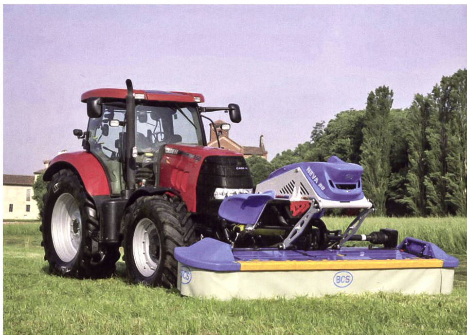
Die neuen Neva-Frontmähwerke von BCS sind mit einem Deflektorsystem ausgerüstet, das Staub und Partikel während des Mähens von der Kühlung des Traktors fernhalten soll.
