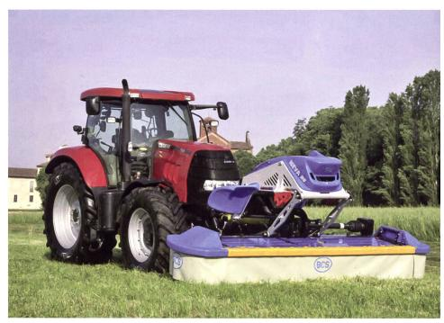
Die neuen Neva-Frontmähwerke von BCS sind mit einem Deflektorsystem ausgerüstet, das Staub und Partikel während des Mähens von der Kühlung des Traktors fernhalten soll.
