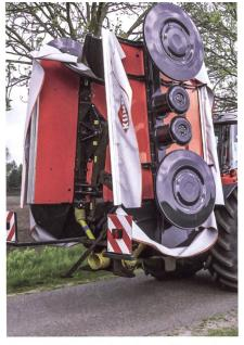
Trommelmähwerke sind oben geführt und haben freidrehende Gleitteller. Die Trommeln können unterschiedlich gross sein.
