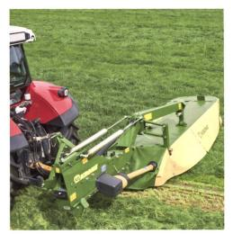
Jeweils die Hälfte des Mähbalkens wird über eine der beiden Spiralfedern entlastet. Durch das Wechselspiel der beiden Federn bleibt der Auflagedruck auf der ganzen Schnittbreite gleich.
