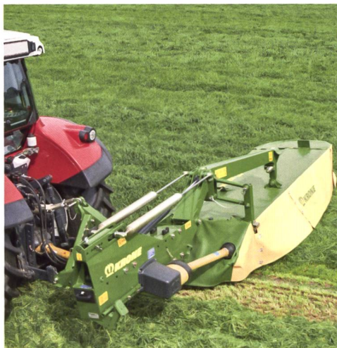
Jeweils die Hälfte des Mähbalkens wird über eine der beiden Spiralfedern entlastet. Durch das Wechselspiel der beiden Federn bleibt der Auflagedruck auf der ganzen Schnittbreite gleich.
