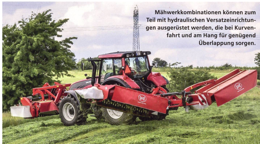
Mit Kombinationen aus Front- und Heckmähdwerken sind Arbeitsbreiten bis 12 m möglich. Damit werden aber die Grenzen des sinnvoll Machbaren erreicht.
