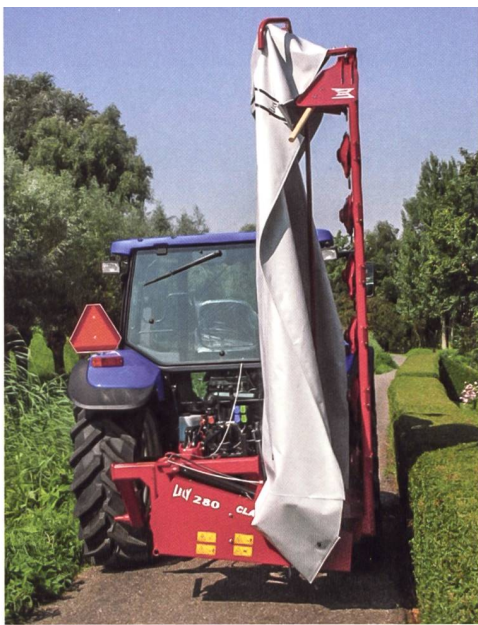
Scheibenmähwerke haben einen unten geführten Balken, der als Tragelement für die Mähscheiben dient.
