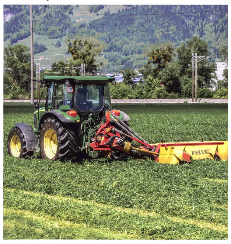
Heckmähwerke haben mit rund 4 m Arbeitsbreite die Grenze zur optimalen Bodenanpassung erreicht. Entlastungssysteme werden weiter optimiert. Dabei kann festgestellt werden, dass mechanische Entlastungssysteme nach wie vor aktuell sind. Diese sind einfach gebaut und reagieren bei schneller Fahrt rasch. Allerdings mit dem bekannten Handicap, dass sie in der Praxis selten eingestellt werden! Deshalb bieten (fast) alle Hersteller Federentlastungssysteme an, die hydraulisch verstellt werden.
