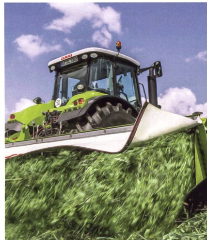
Nach einer Grundeinstellung erfolgt die Anpassung der hydraulischen oder hydropneumatischen Mähwerkentlastung vom Fahrersitz aus.
