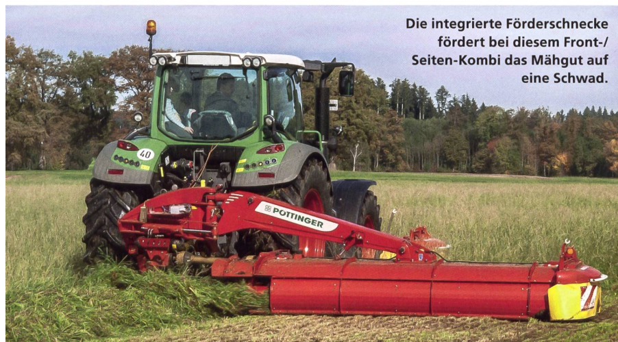
Die Bandschwadzusammenführung kann je nach Futteranfall und weiterer Bearbeitung ein- oder beidseitig erfolgen.
