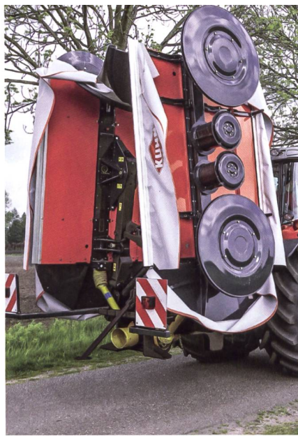
Trommelmähwerke sind oben geführt und haben freidrehende Gleitteller. Die Trommeln können unterschiedlich gross sein.
