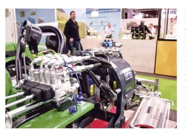
Silent AG in Otelfingen ZH zeigte den neuen Mulcher Bio-Liner II für den Front- und Heckanbau an Rebbautraktoren. Die Rollen mit den Nylonfadenpaketen sind am Tragrahmen höhenverstellbar angebaut. Deren Tastarme erlauben die mechanische Unkrautbekämpfung in den Rebreihen. Die Hydraulik des Gerätes bedingt eine grosse Ölfördermenge. Es wird deshalb eine Version mit als auch eine ohne eigene Ölversorgung angeboten.
