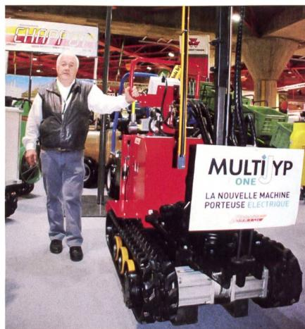
benen Weinbaugeräteträger «Multi-Jyp E-One». Der Prototyp ist mit vier Batterien bestückt, von denen zwei den Elektroantrieb speisen. Eine weitere «Challenge» werde die Entwicklung dazu passender Elektroanbaugeräte sein, sagte Jean-Yves Chappot (Bild).
