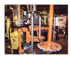
be drückt das Holz gegen eine Kette und zu einem Radpaar mit gegenläufigem Drehsinn. Dieses zieht das abgeschnittene Rebholz aus der Drahtanlage. Der Rebholzzieher, aufgebaut auf einem Weinbautraktor, ersetzt die mühsame Handarbeit beim seitlichen Herausziehen des abgeschnittenen Rebholzes.
