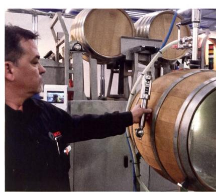
wassers aus den Behältern. Durch den hydraulischen Antrieb kann bei gleichbleibendem Reinigungsergebnis im Vergleich zu elektrischen Antrieben eine höhere Arbeitssicherheit gewährleistet werden.
