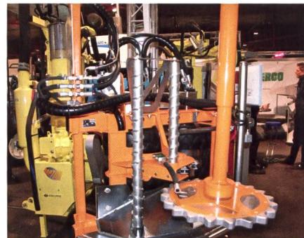
be drückt das Holz gegen eine Kette und zu einem Radpaar mit gegenläufigem Drehsinn. Dieses zieht das abgeschnittene Reholz aus der Drahtanlage. Der Reholzzieher, aufgebaut auf einem Weinbautraktor, ersetzt die mühsame Handarbeit beim seitlichen Herausziehen des abgeschnittenen Reholzes.
