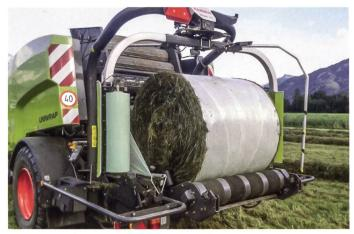
Das Lohnunternehmen «Good-Silage» setzt auf Claas-Pressen mit Folienbindung und ist überzeugt, dass die zusätzliche Drehung vor dem Abwerfen der gewickelten Balle ein entscheidendes Detail ist.
