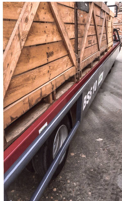
Beim Be- und Entladen sind die Seitengitter unterhalb der Ladefläche, sodass auch das ungehinderte Beladen mit einem Stapler möglich ist.
