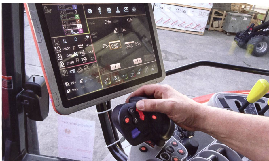
«Premium»-Ausstattung: Komfort-Armlehnenbedienung mit Multifunktionshebel (Hydraulik- und Getriebefunktionen), elektrischen Steuergeräten und Isobus-Terminal.
