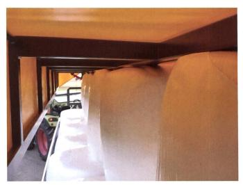
Die obere Ballenlage wird durch den Hauptrahmen der Dachkonstruktion mit grosser Kraft gegen die Ladefläche gedrückt.
