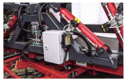
Jeder Hydraulikzylinder ist mit einem eigenen, elektrisch betätigten Ventil ausgestattet. Der Steuerungskasten an der Vorderseite des Wagens ist mit einer Folientastatur für die Notbedienung ausgerüstet.
