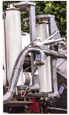
Kuhn schwenkt die Folienrollen für den Bindevorgang um 90° (Bild Ruhezustand). Unter der Folieneinführung ist die Netzrolle für die alternative Netzbindung sichtbar.
