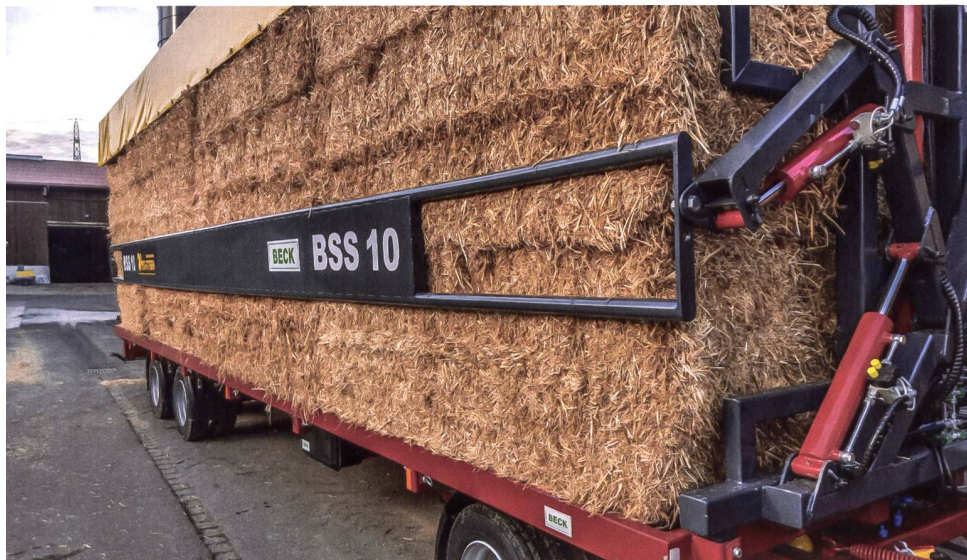
Die Höhe der Seitengitter kann dank Doppelgelenken an unterschiedliche Ballenmasse angepasst werden. Bilder Ruedi Burkhalter/Joël Mosimann
