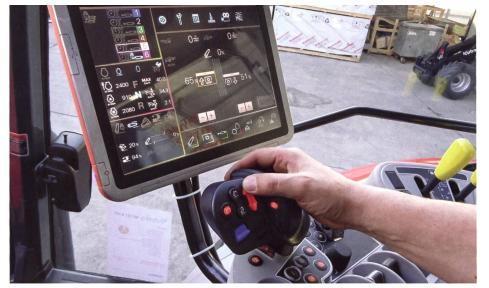
«Premium»-Ausstattung: Komfort-Armlehnenbedienung mit Multifunktionshebel (Hydraulik- und Getriebefunktionen), elektrischen Steuergeräten und Isobus-Terminal.
