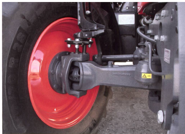
Die Vorderachse mit der Längsschwingenfederung stammt von Dana.
