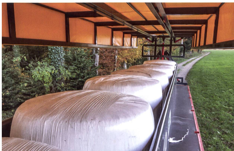
Die Seitengitter können bis auf einen Abstand von einem Meter auch Ladungen innerhalb der Ladefläche festklemmen.
