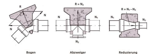
Bei Leitungen mit Steckmuffenrohren müssen die Bogen, Abzweiger, Reduktionen und Endstücke mit stabilen Betonfundamenten abgestützt werden.
