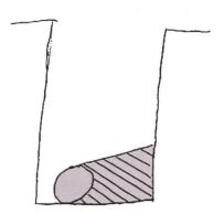
Die Betonfundamente (hier ein Abzweiger) sollen so ausgeführt werden, dass der Druck gegen die feste Grabenwand abstützt.
