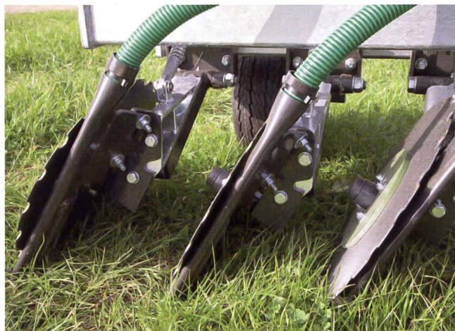
Der Scheibenschlitz-Verteiler von Fliegl kann entsprechend dem eingestellten Winkel den Boden auch seitlich anschneiden. Der Scheibendurchmesser beträgt 530 mm. Bild: Fliegl
