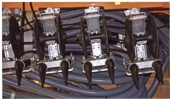
**Eidam** Landtechnik. Firmenchef Hendryk Eidam legt Wert auf die Feststellung, dass jede Kufe einen Anpressdruck von 6 bis 12 kg auf den Boden bringt. Das von Tasträdern geführte Aggregat verfügt über einen Pendelausgleich der Seitenteile.
