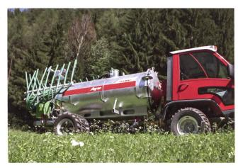
Schleppschlauch-Verteiltechnik ist in angepasster Grösse auch mit Berg- und Hangmechanisierung einsetzbar.
