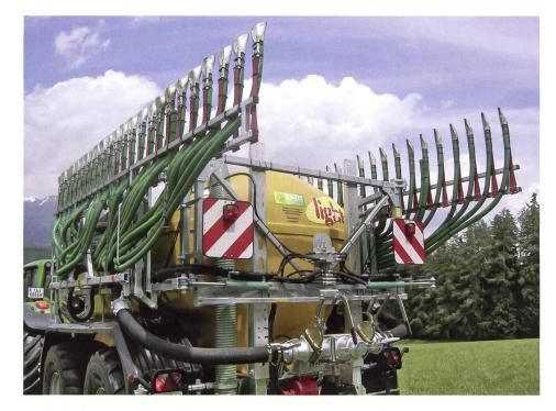
Dank kompakter Bauweise können Schleppschuh-Gestänge seitlich zum Fass geklappt werden und stellen für übrige Verkehrsteilnehmer keine Gefahr dar.
