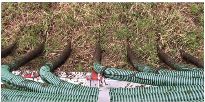
Der Schleppschuh-Verteiler öffnet die Grasnarbe und verhindert damit Grasverschmutzungen, zudem werden Emissionen dank direktem Bodenkontakt stark reduziert.
