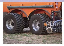
Das hohe Gewicht wird durch eine quer zur Fahrtrichtung verschiebbare Achse auf eine breitere Auflagefläche verteilt. Die nachfolgende Lenkachse ermöglicht ein Fahren im «Hundegang», wodurch das Spur-auf-Spur-Fahren verhindert wird.
