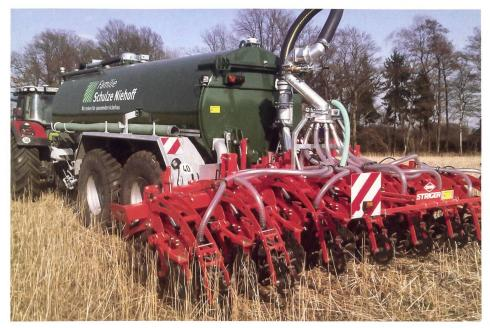
Luftbalgen am Verteilkopf verschlossen, die Scheiben bleiben aber im Boden. Auf der höchsten Ausbaustufe werden beide Verfahren kombiniert. Damit der Gülleausfluss in den noch offenen Sektoren möglichst gleichbleibend ist, regelt Vredo auch die Pumpen(-Drehzahl).
