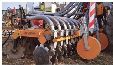
Die beiden Arbeitsschritte Bodenbearbeitung und Gülleausbringung bzw. -einarbeitung sind kombiniert. Das spart Zeit und Kosten und sorgt dafür, dass die Gülle unmittelbar eingearbeitet wird.
