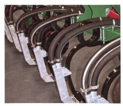
Gülleeinleger an den 40 × 40 mm Spiralfederzinken der Lomma-Güllegrubber. Die Gülle wird über zwei Schläuche (Aussenzinken drei) zugeführt.
