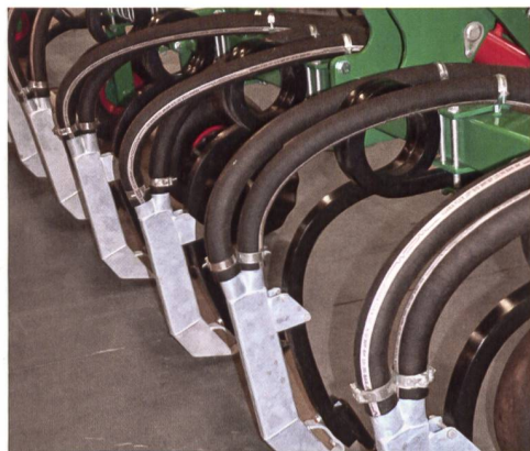
Güleeinleger an den 40 x 40 mm Spiralfederzinken der Lomma-Güllegrubber. Die Gülle wird über zwei Schläuche (Aussenzinken drei) zugeführt.
