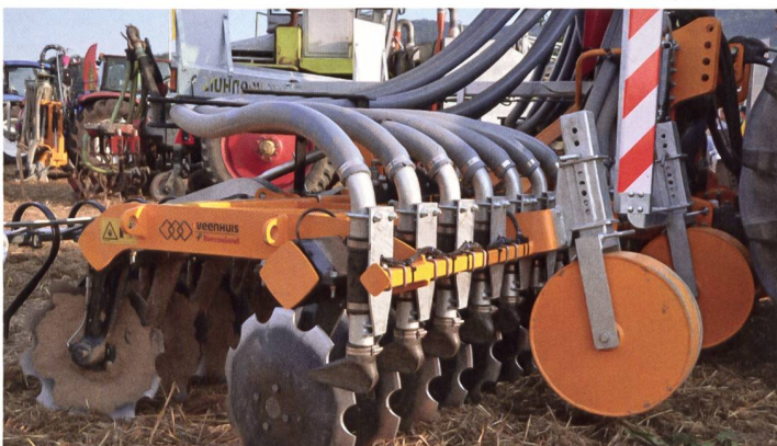
Die beiden Arbeitsschritte Bodenbearbeitung und Gülleausbringung bzw. -earbeitung sind kombiniert. Das spart Zeit und Kosten und sorgt dafür, dass die Gülle unmittelbar eingearbeitet wird.
