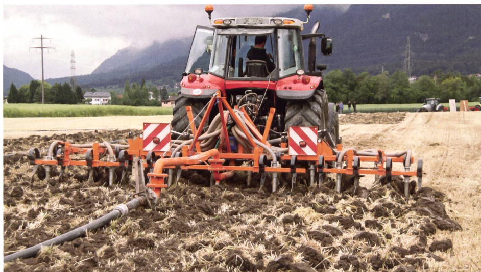
Anbau-Güllegrubber mit Schlauchführungssystemen sind eine echte Alternative im Kampf gegen die (zu) hohen Gewichte der Gülletechnik.
