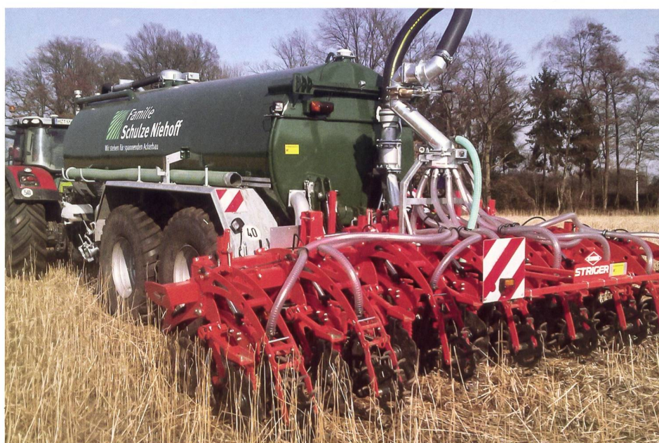
1 = Schneidscheibe mit Tiefenbegrenzung; 2 = Räum-scheiben; 3 = Injek-torzinken zum Einlegen der Gülle.
