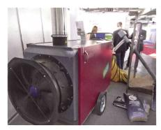
Einen mobilen Warmlufterzeuger für Holzpellets stellte die Firma Energynova, Diessenhofen TG, vor. Die Feuerung wird in drei Grössen von 120 bis 230 kW angeboten.
