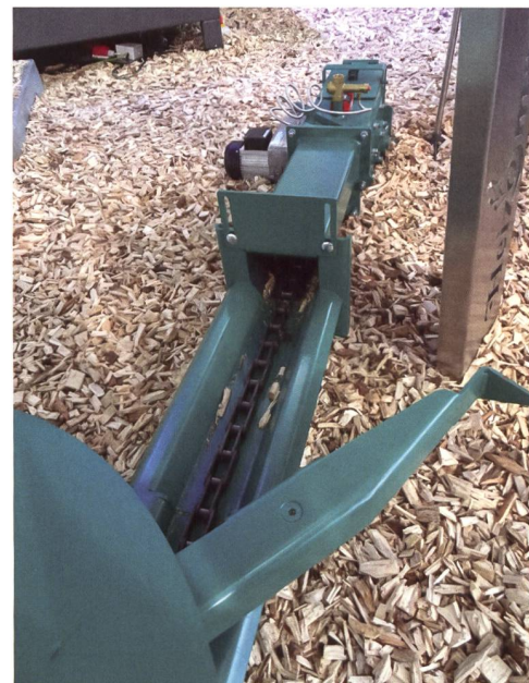
Heizomat fördert Hackschnitzel aus dem Lager zum Kessel per Kette statt Schnecke. Störungsfreier Betrieb, geringerer Verschleiss und 50 % Energieeinsparung werden als Vorteile genannt.
