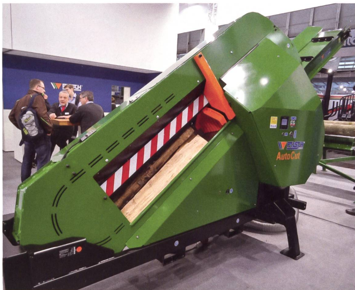
Posch AutoCut, eine Säge mit digitaler Schnittlängenkontrolle, Preis: 21000€. Bilder: C. Brüggemann
