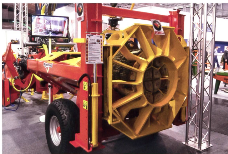
Der Liegendspalter F80 von Rabaud arbeitet mit 80t Spaltkraft und kann je Hub bis zu 28 Scheite produzieren.
