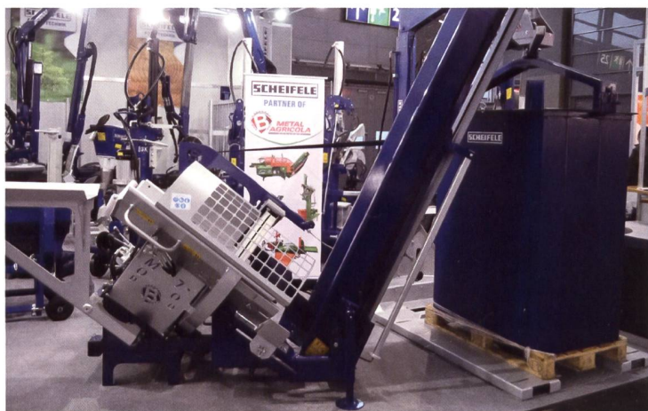
Wippsäge mit schräger Zuführung der Firma Scheifele, dahinter ein rechteckiger Trommelwickler. So können Europaletten optimal genutzt werden.
