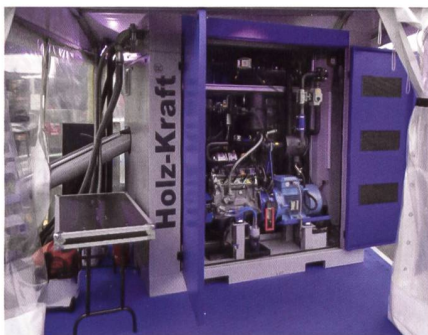
Spanner-Holzvergaser mit 9kW elektrischer und 25 kW thermischer Leistung.
