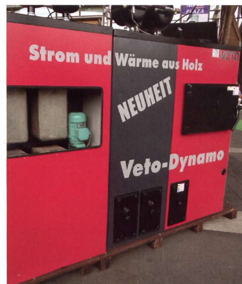
Holz hackschnitzelfeuerung mit ORC-Prozess zur Strom- und Wärmeerzeugung von Ala Talkkari.
