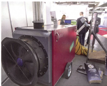
Einen mobilen Warmluftzeuger für Holzpellets stellte die Firma Energynova, Diessenhofen TG, vor. Die Feuerung wird in drei Grössen von 120 bis 230kW angeboten.
