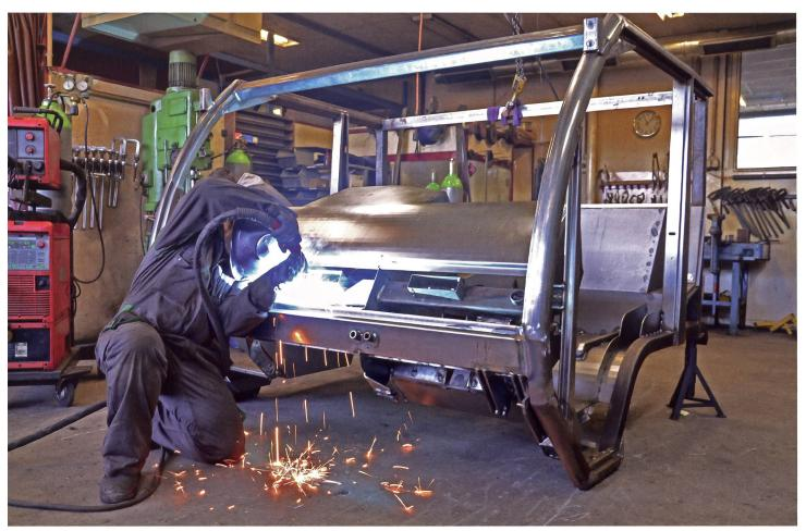
Ein Schiltrac entsteht. Die Kabine mit der inhouse designten runden Kabinenfront wird nach OECD-Richtlinie in Buochs selbst gefertigt und montiert.
