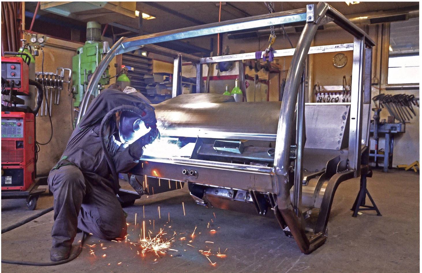
Ein Schiltrac entsteht. Die Kabine mit der inhouse designten runden Kabinenfront wird nach OECD-Richtlinie in Buochs selbst gefertigt und montiert.
