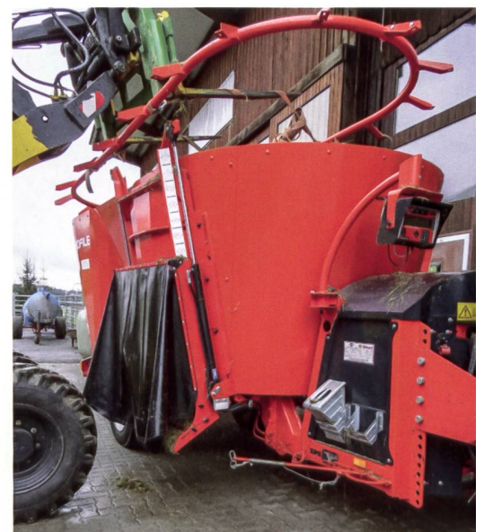
Der demontierte Überlaufing bringt 13cm weniger Maschinenhöhe. Bei hohem Dürrfutteranteil sollte er aber dranbleiben.
