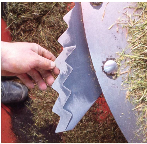
Die Chromkarbidbeschichtung auf beiden Schneidenseiten ist nach drei Wochen noch wie neu, der hintere, nicht beschichtete Teil wenig abgenutzt.
