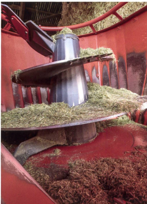
Die Chromkarbidbeschichtung auf beiden Schneidenseiten ist nach drei Wochen noch wie neu, der hintere, nicht beschichtete Teil wenig abgenutzt.
