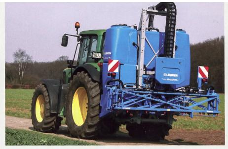
An Pflanzenschutzspritzen mit überstehenden Teilen sind sowohl nach vorne wie auch nach hinten geeignete Markierungstafeln anzubringen. Diese sind, wie auch die Beleuchtungsanlage, so zu montieren, dass sie möglichst nicht verschmutzen und keine Sichtwinkeleinschränkung aufweisen. Werkbild
