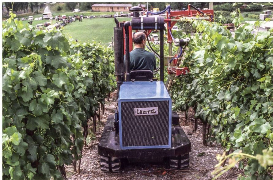
Fahrzeuge für den Weinbau sind schmal und haben oft ein reduziertes Sichtfeld. Der Fahrerschutz ist unerlässlich, auch als Schutz vor Drähten. Eine gute Fahrerschulung ist zwingend. Bilder: Beratungsstelle für Unfallverhütung in der Landwirtschaft
