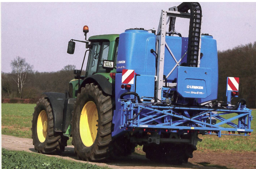
An Pflanzenschutzspritzen mit überstehenden Teilen sind sowohl nach vorne wie auch nach hinten geeignete Markierungstafeln anzubringen. Diese sind, wie auch die Beleuchtungsanlage, so zu montieren, dass sie möglichst nicht verschmutzen und keine Sichtwinkeleinschränkung aufweisen. Werkbild
