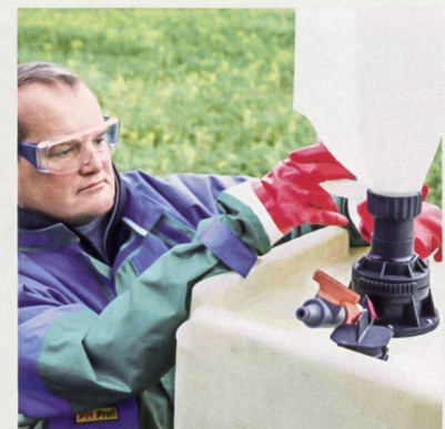
«Jeder Tropfen zählt»: spritzfreies Einfüllsystem für Pflanzenschutzmittel.
