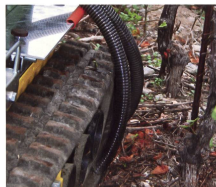
Seitlich am Düngestreuer angebrachte Rohre bringen den Dünger präzise an die Rebstöcke heran.
