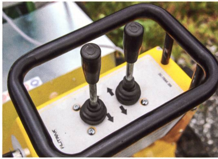
Die Steuerung des Raupentransporters wirkt direkt auf die beiden Raupen.
