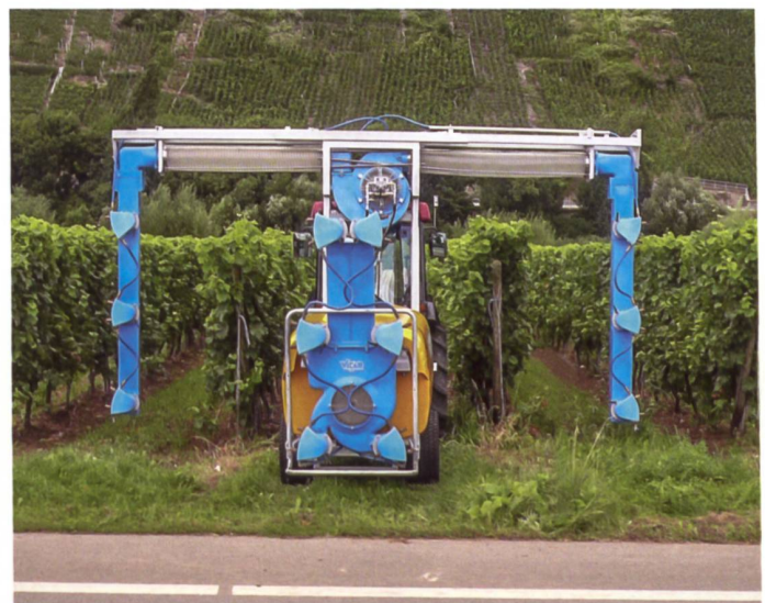
Überzeilen-Sprühgerät von «Sexauer-Vicar». Die verstellbaren Düsenfächer können der Laub- bzw. Pflanzenhöhe angepasst werden.
