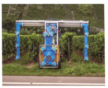
Überzeilen-Sprühgerät von «Sexauer-Vicar». Die verstellbaren Düsenfächer können der Laub- bzw. Pflanzenhöhe angepasst werden.
