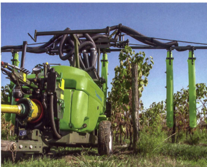
Gezogenes Überzeilen-Sprühgerät von «Technoma», ausgerüstet mit einem Radialgebläse und senkrecht hängender Sprüheinrichtung.
