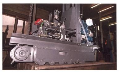
Die einheimischen Gerätehersteller legen grossen Wert auf eine robuste Stabilität des Raupenlaufwerks. Diese ist bei Maschinen ab der Stange oftmals ein Schwachpunkt.
