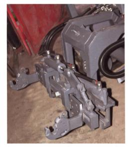
Dreipunkthydraulik des «Viti-plus» mit Verschiebezylinder, speziell gedacht für die Pflegegeräte im Rebbau.
