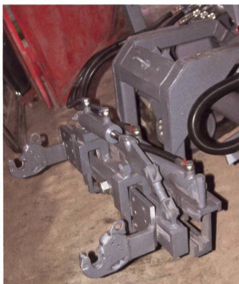
Dreipunkthydraulik des «Viti-plus» mit Verschiebezylinder, speziell gedacht für die Pflegegeräte im Rebberg.
