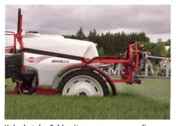
Kuhn hat das Feldspritzenprogramm um die gezogene «Lexis 3000» erweitert. Die einfach zu bedienende Feldspritze ist mit Aluminiumspritzbalken von 18 bis 24m erhältlich. Bild: Kuhn, Saverne
