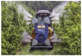
Sprühgerät von Sexauer/Vicar mit Radialgebläse und Düsenfächer. Bild: Werkbild
