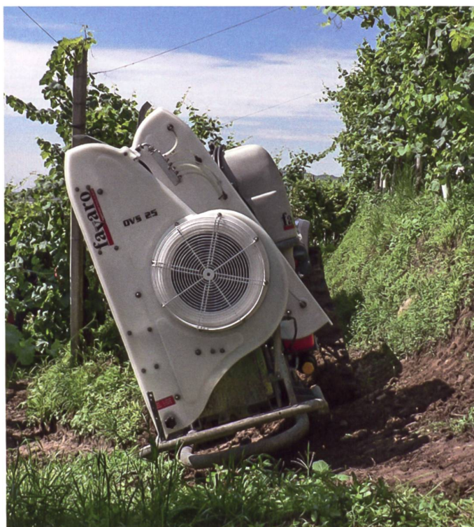
Doppelradialgebläse mit Querstromcharakteristik als Anbaugerät auch für schwierige Einsatzbedingungen.
