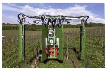
Tangentialgebläse sind strömungstechnisch eine Besonderheit. Sie überzeugen durch ein nahezu horizontales, gleichmässiges Luftstromprofil. Bild: Werkbild
