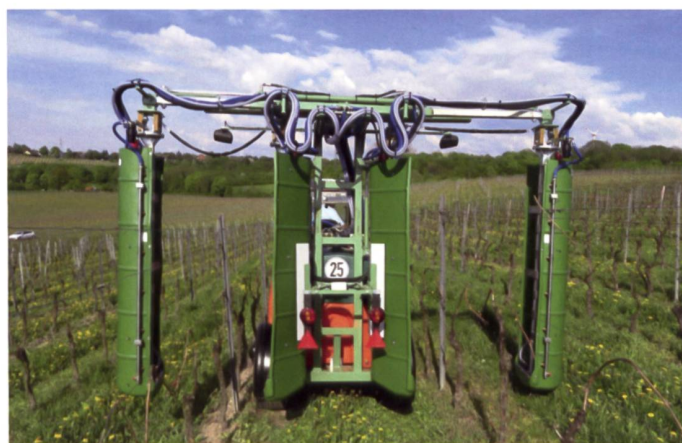
Tangentialgebläse sind strömungstechnisch eine Besonderheit. Sie überzeugen durch ein nahezu horizontales, gleichmässiges Luftstromprofil. Bild: Werkbild
