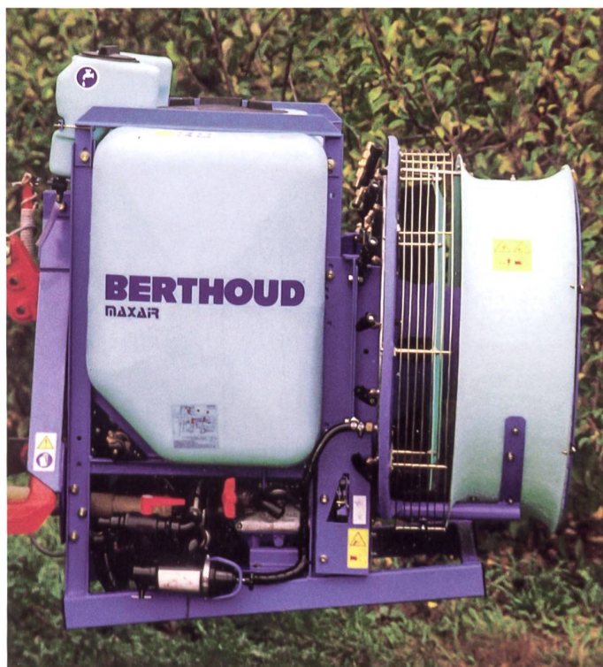
Axial-Gebläsespritzen sind als Anbaugeräte an Traktoren flexibel einsetzbar.
