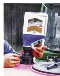
Mit einem geschlossenen Einfüll- und Entnahmesystem werden Spritzer vermieden sowie Mensch und Umwelt geschützt.
