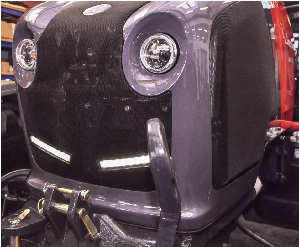
LED-Tagfahrlichter können vom Landmaschinenhändler nachgerüstet werden oder sind bereits, wie beim Lindner-«Geotrac 134ep», ab Werk montiert.
