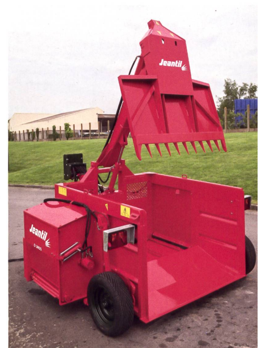
Selbstfüllende Entnahmegeräte gibt es mit oder ohne Teleskoparm, das Entnahmeschild wird hydraulisch bewegt.
