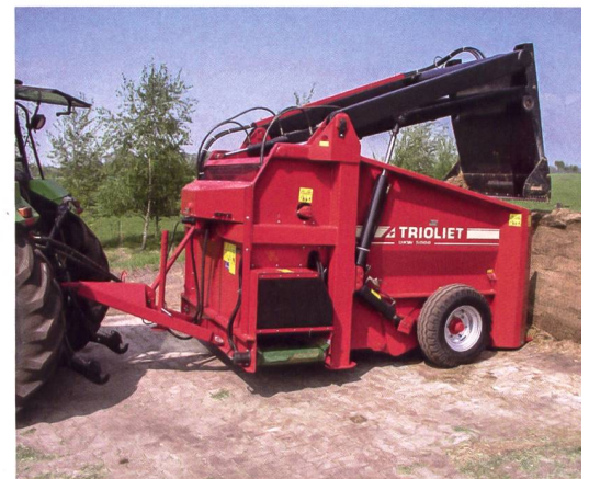
Trioliet hat ein klassisches, fahrbares Entnahmegerät für Fahrsilos im Programm.
