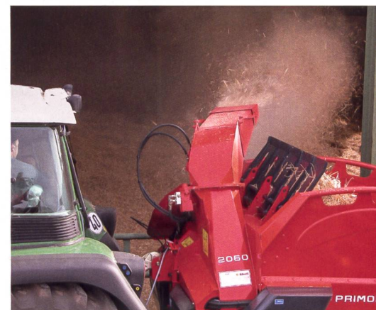
Der «Primor» von Kuhn ist ein typischer Vertreter der Kombi-Geräte. Mit ihnen kann sowohl Futter ausgetragen als auch Stroh eingeblasen werden.
