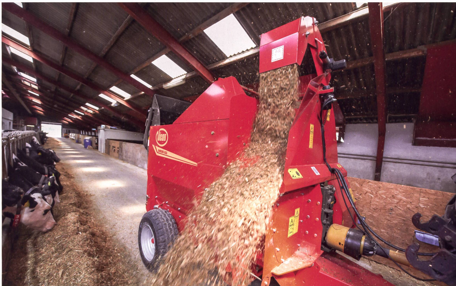
Beim Vicon «Shredex» wird das Futter in Form von Heu und Silage über die Futterrutsche direkt auf dem Futtertisch abgelegt.
